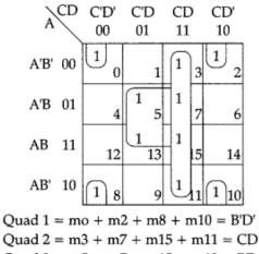
Quad 3 = m5 + m7 + m15 + m13 = BDMinimal SOP = B'D' + CD + BD
